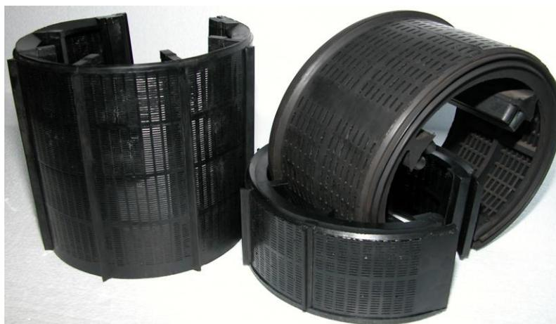
Рис. 3 – Просеивающие элементы СДАЛ с кольцевым несущим органом
